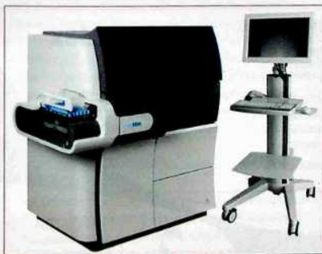
Рис. 4.22. Автоматизированный анализатор гемостаза STA R Max – выполняет клоттинговые (оснащен вискозиметрической системой детекции), хромогенные, иммунологические методики, предназначен для крупных лабораторий с потоком исследований гемостаза более 100 образцов в день
