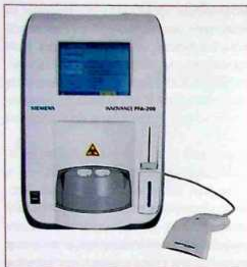
Рис. 4.16. Анализатор функции тромбоцитов PFA-200. Позволяет наблюдать in vitro в динамике за процессом формирования тромбоцитарной пробки при моделировании этого процесса в специально созданном картридже
