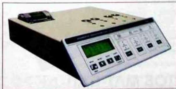
Рис. 4.19. Анализатор показателей гемостаза «ЭМКО» – полуавтоматический программируемый коагулометр, предназначенный для определения в лабораторных условиях параметров свертывающей системы крови механическим методом
