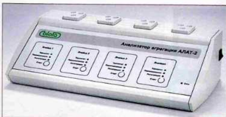
Рис. 4.11. Лазерный анализатор агрегации АЛАТ-2 НПФ БИОЛА. Предназначен для исследования агрегации тромбоцитов, определения концентрации клеток в суспензии, а также оценки их формы. Агрегация регистрируется как традиционным турбидиметрическим методом, так и методом, основанным на оценке среднего размера агрегатов
