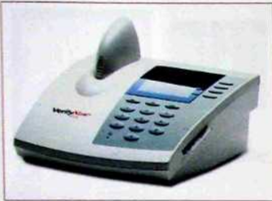
Рис. 4.14. Система VerifyNow основана на методе оптической трансмиссионной агрегометрии (LTA – Light Transmittance Aggregometry), определяет величину прохождения света в зависимости от агрегации тромбоцитов. Результаты, полученные на системе VerifyNow, коррелируют с клиническими исходами при оценке ответа на аспирин, клопидогрел, а также при совместном использовании клопидогреля и аспирина
