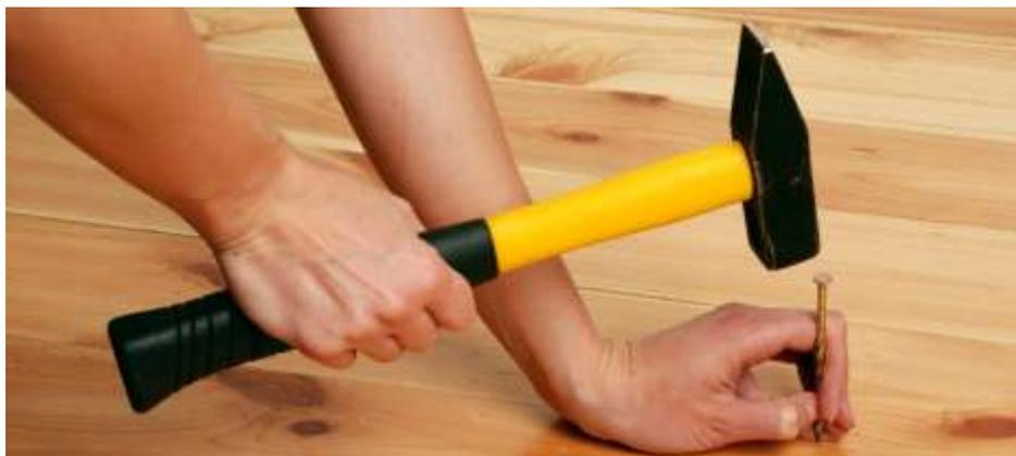
**12-rasm.** Mix qoqayotganda o'naqay bolg'achani o'ng qo'li bilan, mixni esa chap qo'li bilan ushlaydi.
